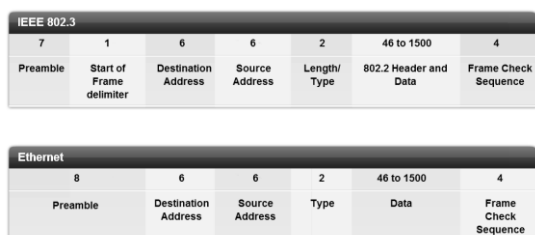
Fig. 9. Formatul frame-ului Ethernet și al frame-ului IEEE802.3
